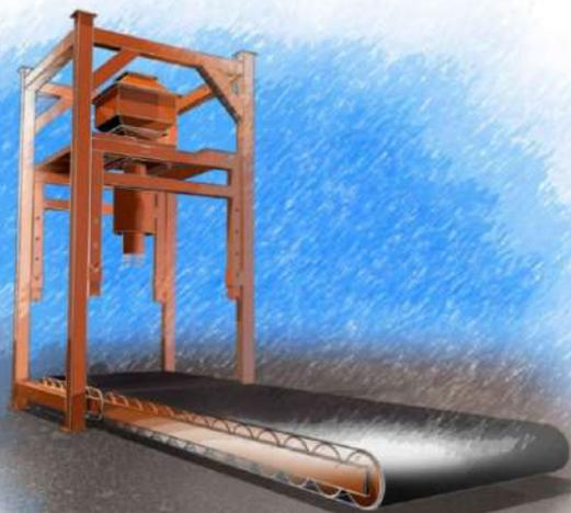
Принцип работы данного весового дозатора заключается в следующем: горловина контейнера Биг-Бэг надевается на патрубок фасовщика, затем оператор включает раздув мешка, нижняя часть контейнера при этом опирается либо на платформенные весы либо на ленточный транспортер со встроенными весами.
