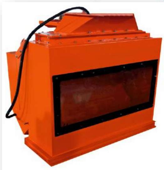
Дозатор сыпучих материалов ЛДНД-П (расходомер) применяется для автоматического непрерывного контроля массового расхода зернистых, порошкообразных и пылевидных сыпучих материалов в свободно текущем потоке. При установке дополнительной задвижки данный вид поточных весов осуществляет функцию дозатора перекрывая поток при достижении заданной дозы материала.
